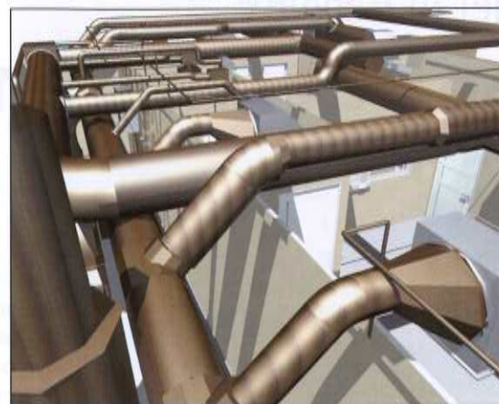
Geen meerwerk meer tijdens de uitvoering; stem installaties nauwkeurig op elkaar af tijdens het ontwerpenproces met behulp van 3D.
